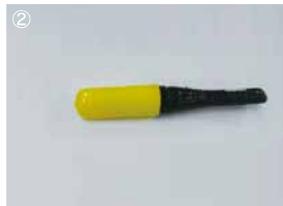
② SP コネクタ用防水接栓を装着した給電線に FK キャップを被せ二重防水。
