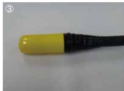
② SP コネクタ用防水接栓を装着した給電線に FK キャップを被せ二重防水。
